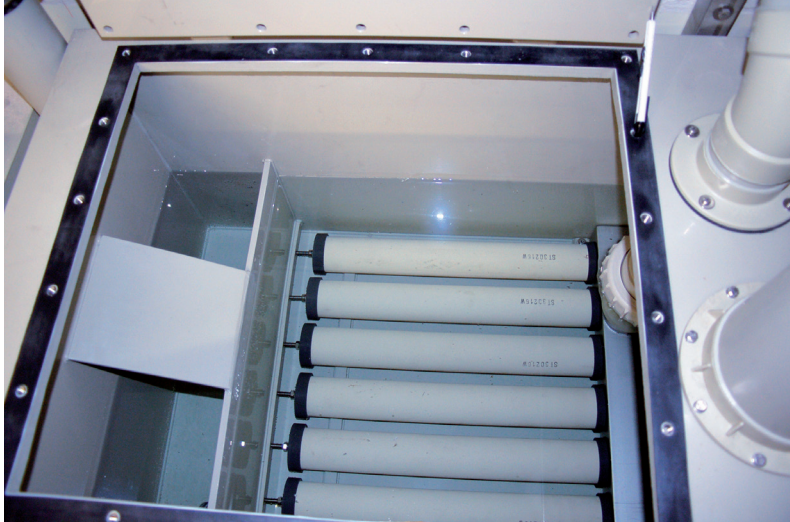
Blick ins Innere des Gehäuses, Belüftungsrohre
