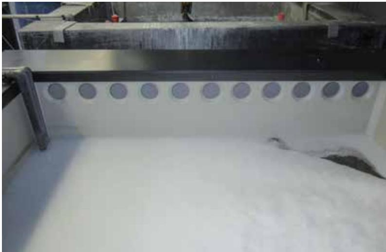
*Königswasserbehälter mit PE-Verschleißschutz - installiert und im Betrieb*
