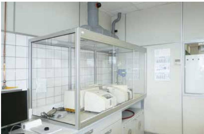
Die IKS Kunststoff- und Stahlverarbeitungs GmbH aus Ingelheim konzipierte und fertigte für diese Aufgabenstellung eine individuelle Einhausung nach den zunächst vor Ort aufgenommenen Maßen. Bis auf den Boden sind die Flächen der Einhausung (Wände und Dach) komplett mit Polycarbonatplatten bestückt.
