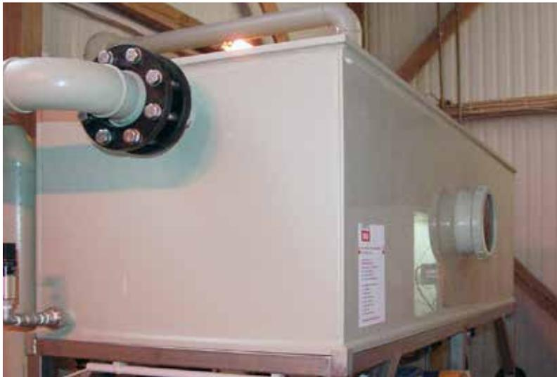
Entsäuerungsanlage, gefertigt aus PP-Plattenmaterial, Stärke: 15 mm
