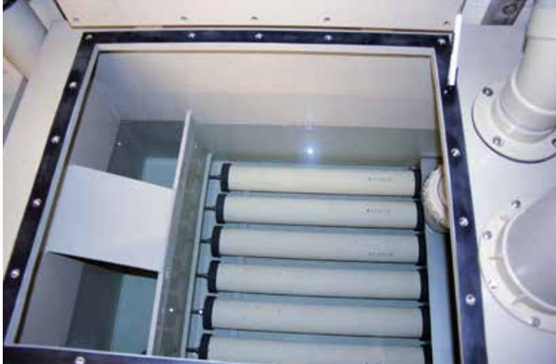
*Blick ins Innere des Gehäuses, Belüftungsrohre*
